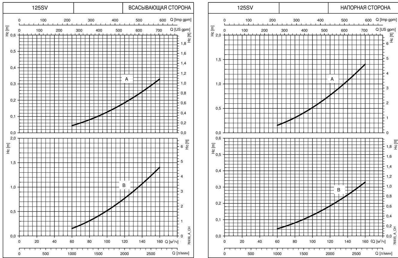
Характеристики приведены для жидкостей с плотностью  $\rho = 1.0 \text{ кг/дм}^3$  и кинематической вязкостью  $\nu = 1 \text{ мм}^2/\text{сек.}$
