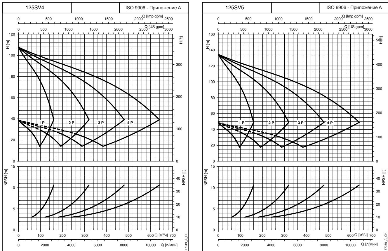
При построении характеристик не учитывались гидравлические потери в клапанах и трубопроводах.
