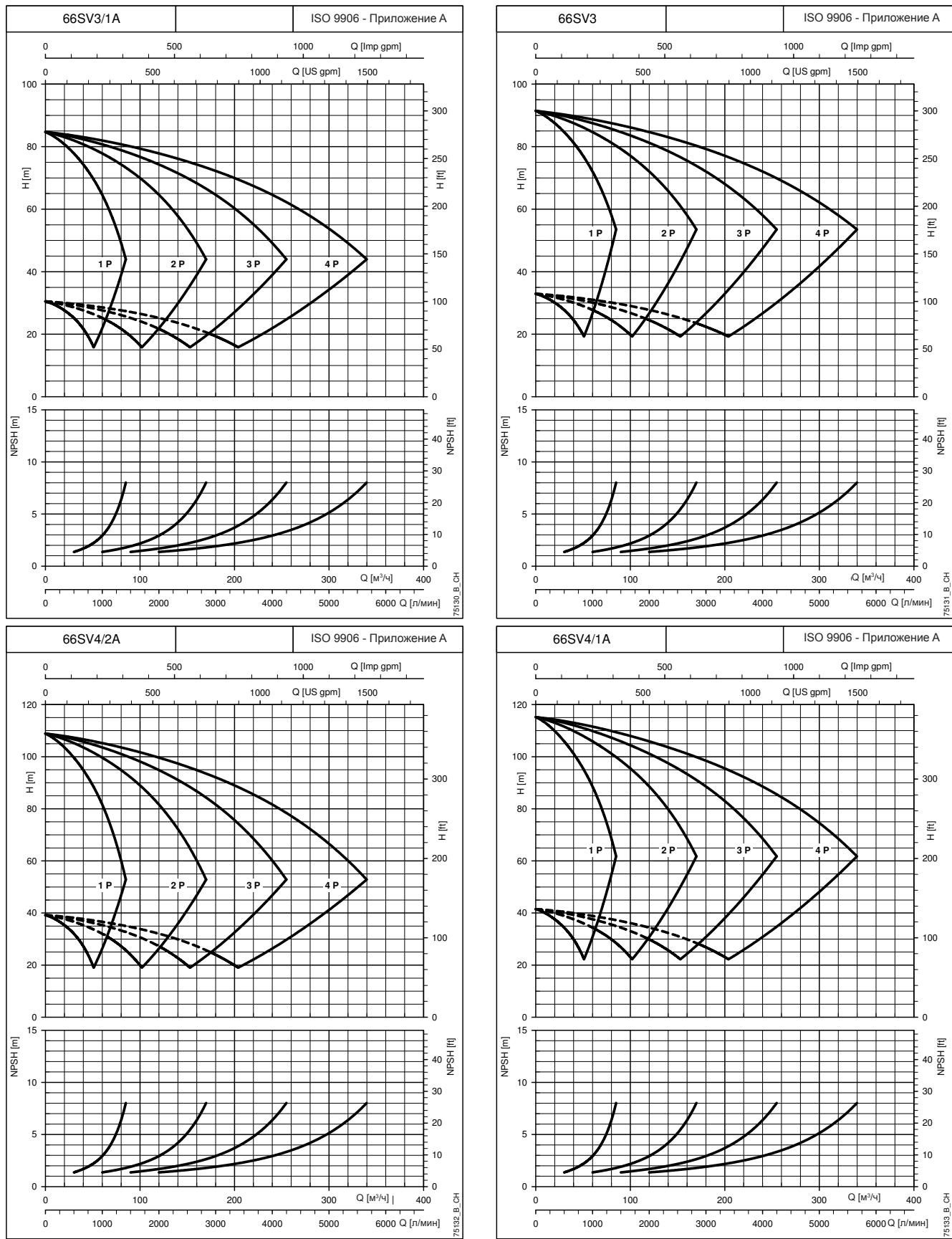
При построении характеристик не учитывались гидравлические потери в клапанах и трубопроводах.
