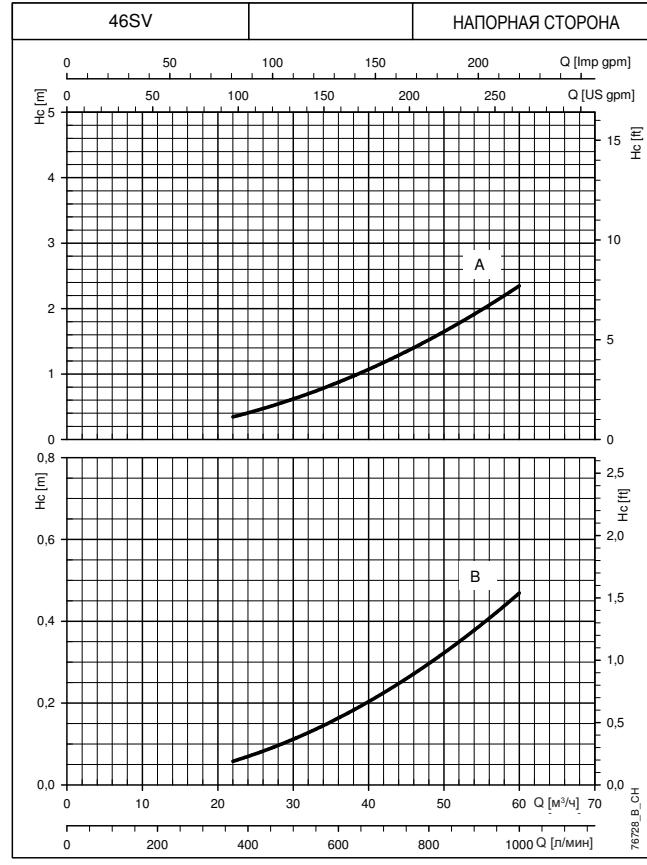
Характеристики приведены для жидкостей с плотностью  $\rho = 1.0 \text{ кг/дм}^3$  и кинематической вязкостью  $\nu = 1 \text{ мм}^2/\text{сек.}$
