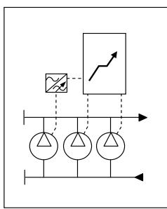
Работой одного насоса управляет частотный преобразователь Master, подключённый непосредственно к электродвигателю. Остальные насосы управляются внешним двухпозиционным сигналом (ВКЛ./ВЫКЛ.) и работают на постоянных оборотах. Регулируемую частоту вращения имеет только насос, подсоединеный к преобразователю частоты. Нерегулируемые насосы запускаются через контакторы, расположенные внутри шкафа управления.
