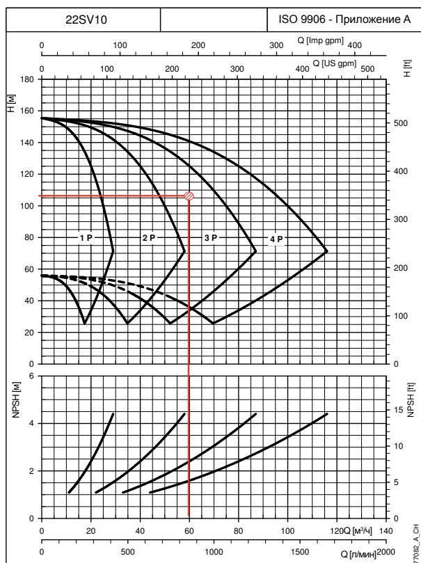
В приведённом рядом примере в качестве исходных берутся расход  $60 \text{ м}^3/\text{ч}$  и давление  $110 \text{ м}$  вод. ст.
