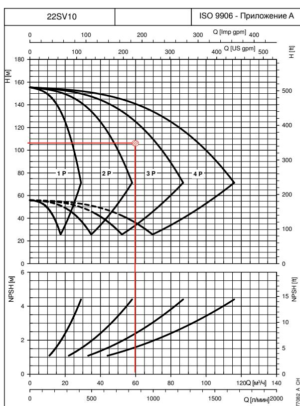
В данном примере мы выбрали насос серии 22SV10. Параметры характеристики немного завышены, но это даёт запас на компенсацию гидравлических потерь в трубопроводах повысительной установки. Для определения эффективного давления на выходе напорного коллектора устанавливаем потери на всасывающей и напорной стороне каждого насоса в отдельности.
