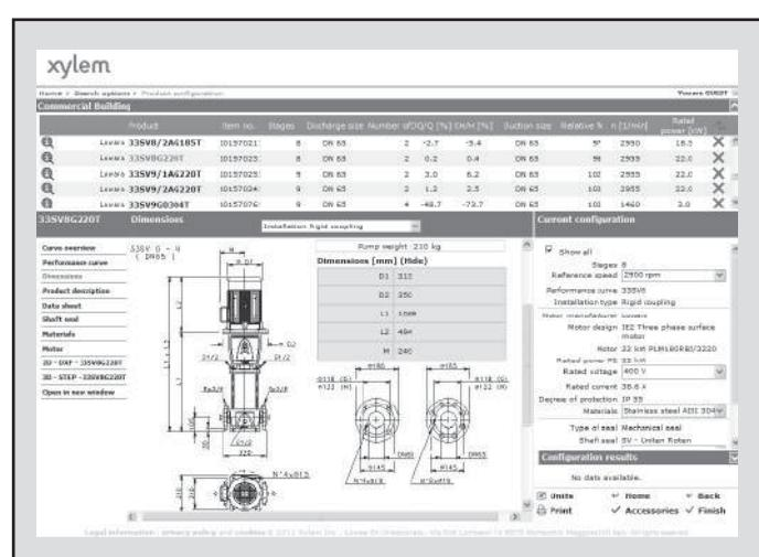
Отображаемые на экране габаритные чертежи можно скачивать в формате .dxf
