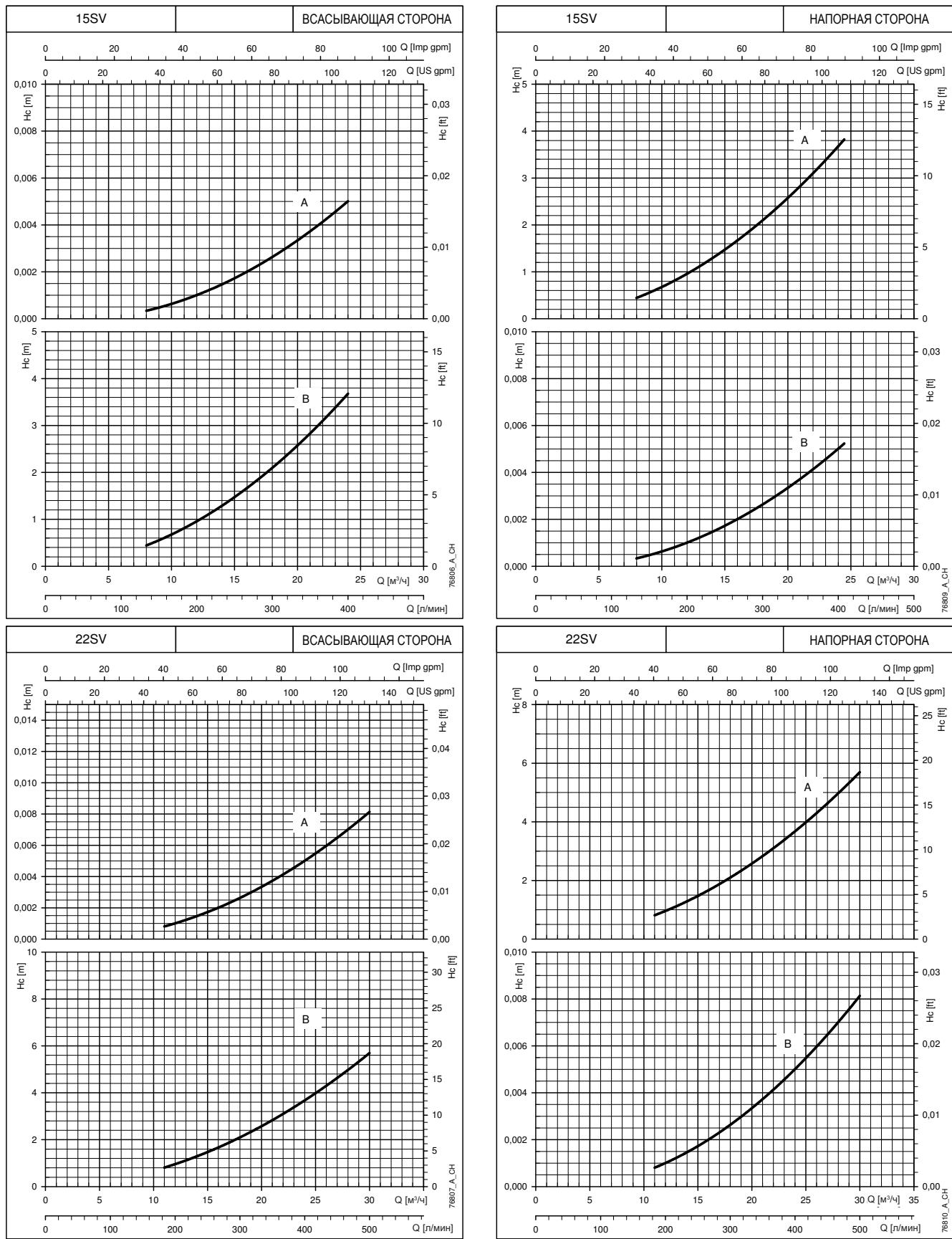
Характеристики приведены для жидкостей с плотностью  $\rho = 1.0 \text{ кг}/\text{дм}^3$  и кинематической вязкостью  $v = 1 \text{ мм}^2/\text{сек}$ .
