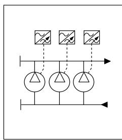
Работой каждого насоса управляет соответствующий преобразователь частоты, подключённый непосредственно к электродвигателю. При каждом новом цикле запуска установки, приоритет включения последовательно переходит от одного насоса к другому. Все насосы работают с регулируемой частотой вращения. У всех насосов частота вращения одинаковая.
