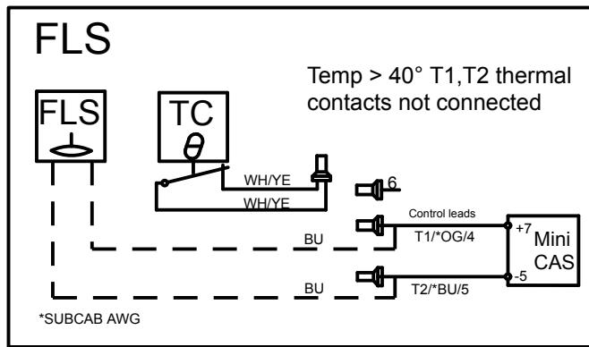
Данное подключение датчика применимо к 1-фазному со встроенным пускателем:
