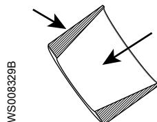
Следует использовать смазку для подшипников, например Exxon Mobil Unirex N3, Mobil Mobilith SHC 220 или аналогичную.
