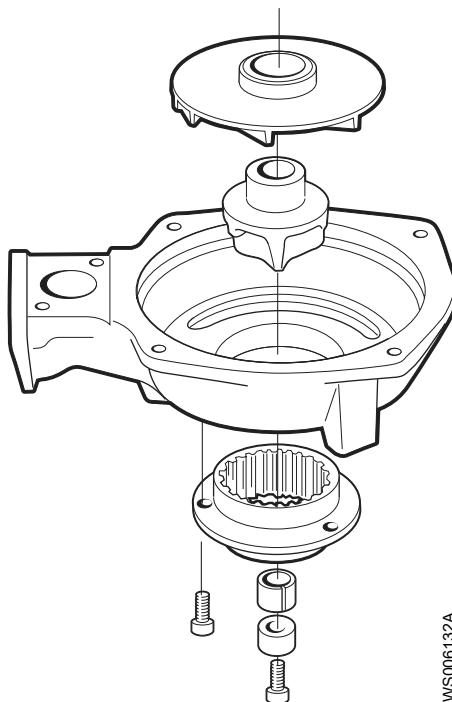
**Рис. 20: Рабочее колесо типа М**
