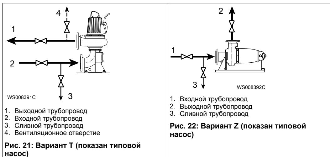
2. Откройте клапан на сливном трубопроводе и слейте жидкость из насоса.
