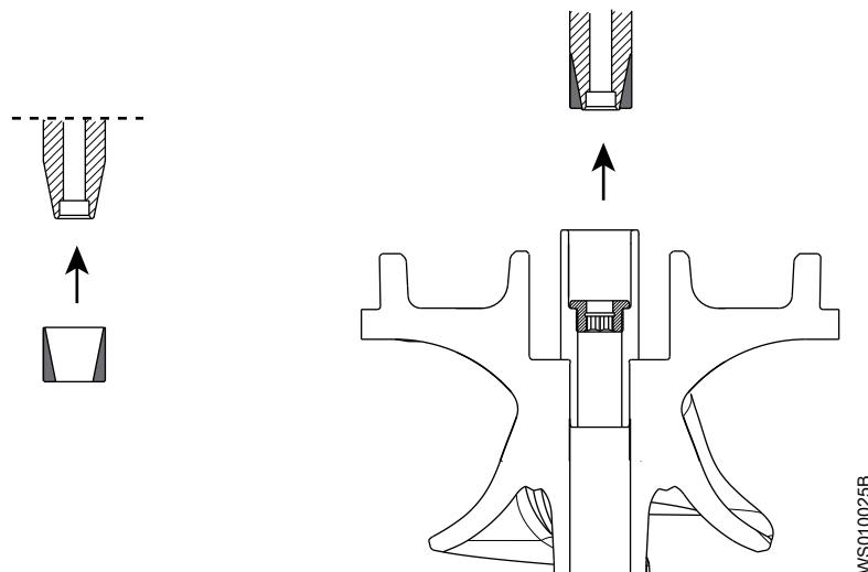
5. Винтом зафиксируйте рабочее колесо.
