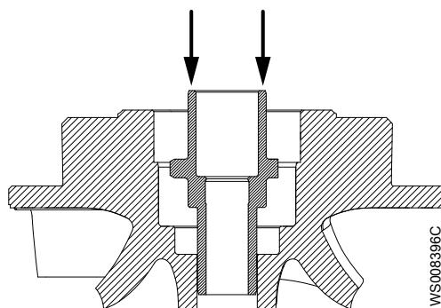
2. Проверьте положение регулировочного винта в новом рабочем колесе.
