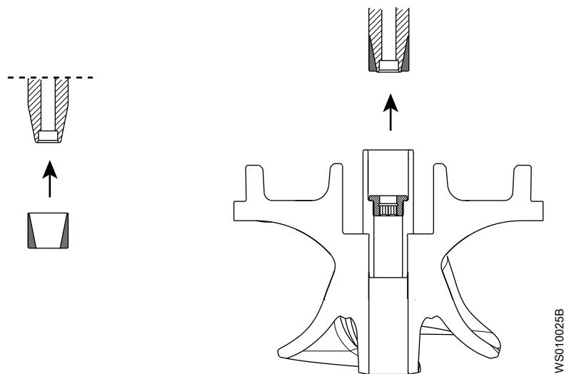
5. Винтом зафиксируйте рабочее колесо.
