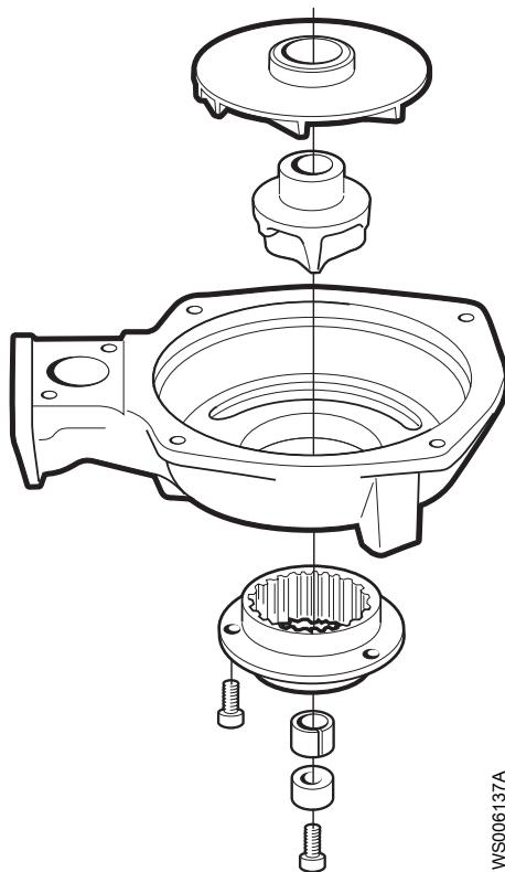
**Рис. 20: Рабочее колесо типа M**
