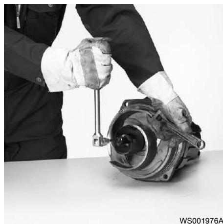
3. Снимите рабочее колесо.
