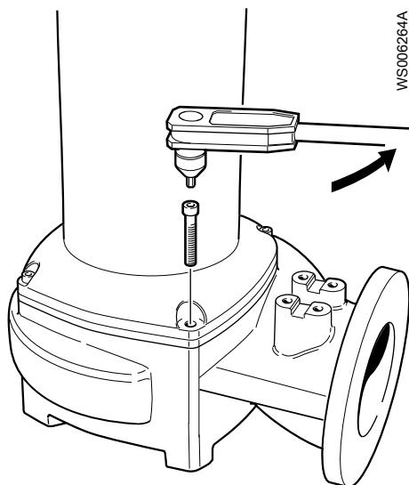
b) Снимите приводной блок с корпуса насоса.
