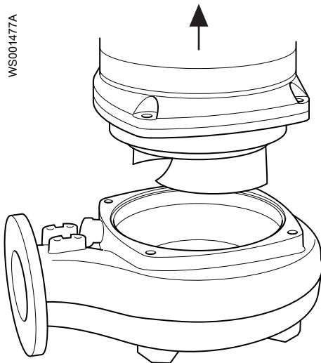
2. Снимите рабочее колесо:
