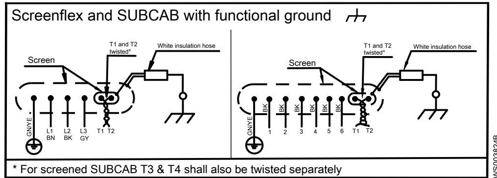
Рис. 19: Кабели Screenflex и SUBCAB с функциональным заземлением
