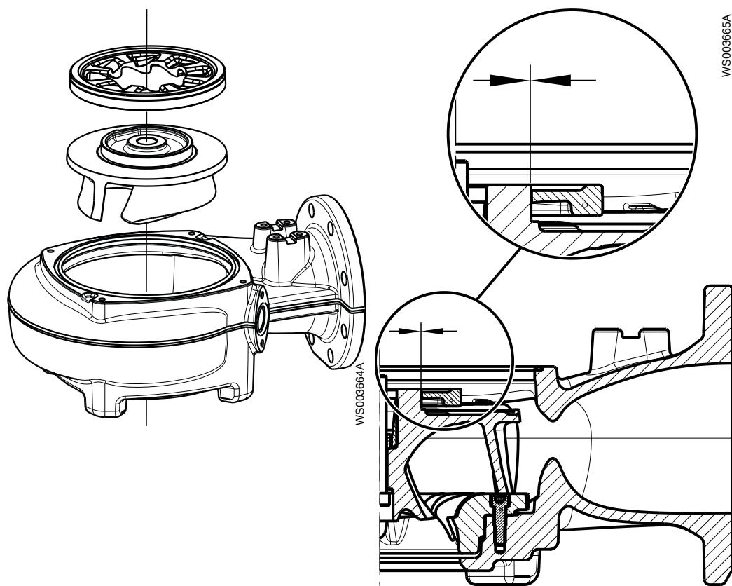
8. Установите приводной блок в корпус насоса:
