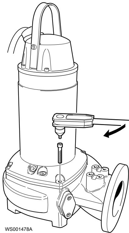
При необходимости выполнения регулировки рабочего колеса выполните процедуру замены рабочего колеса с самого начала.
