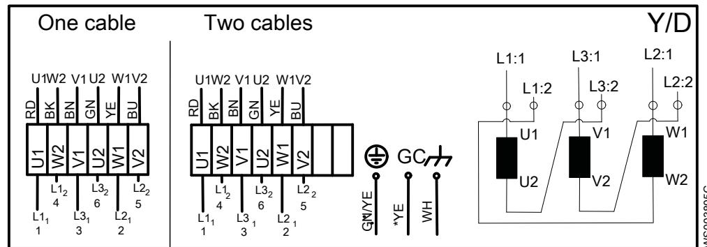
Рис. 14: “Звезда”/“Треугольник”
