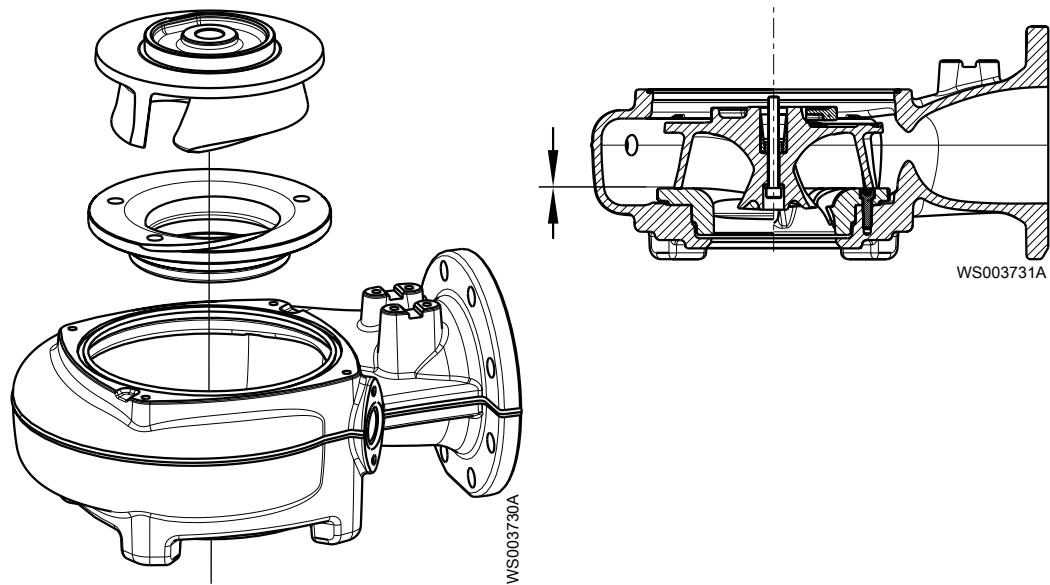
9. Если применимо, отрегулируйте зазор между направляющим штифтом и рабочим колесом, который должен составлять 0,1–0,5 мм (0,004–0,02 дюйма).
