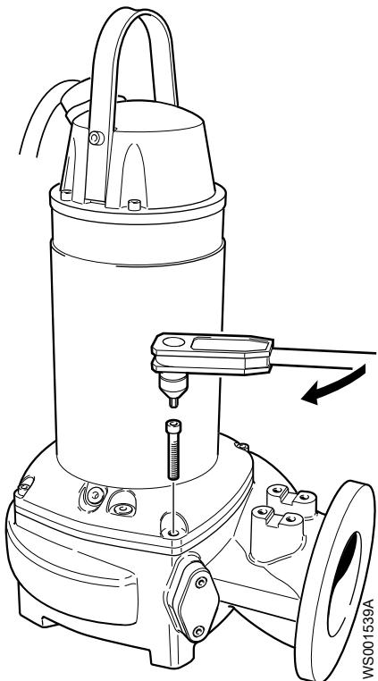
b) Снимите приводной блок с корпуса насоса.
