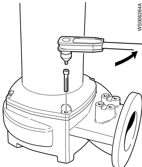
b) Снимите приводной блок с корпуса насоса.
