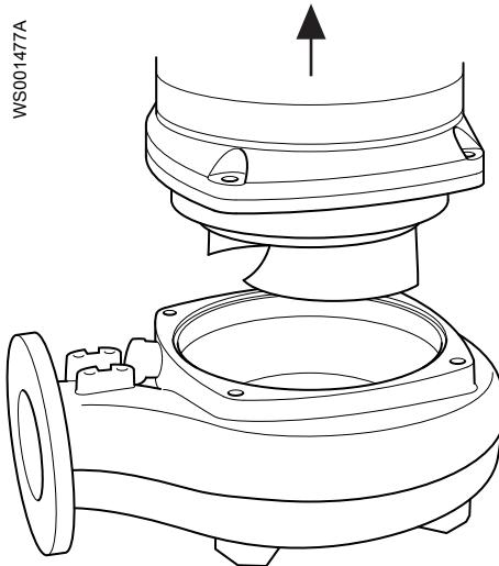
5. Снимите рабочее колесо:
