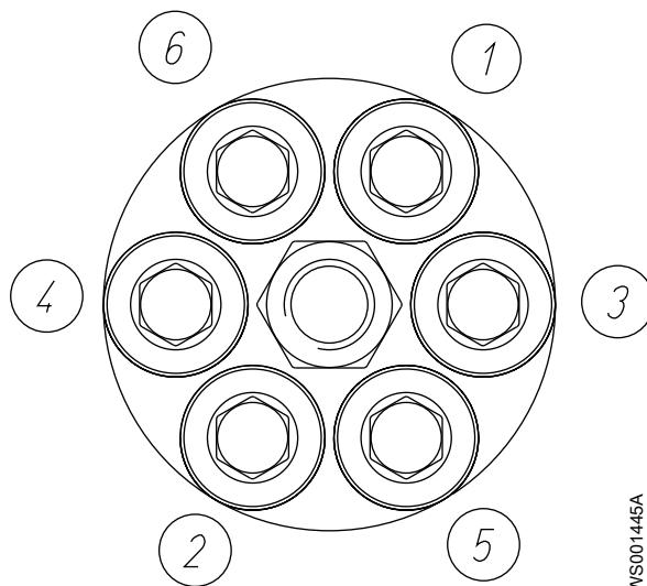
**Рис. 32: Диагональный рисунок для периферийных винтов**
