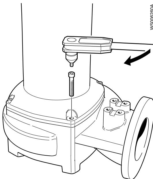
4. Снимите винтовой блок.
