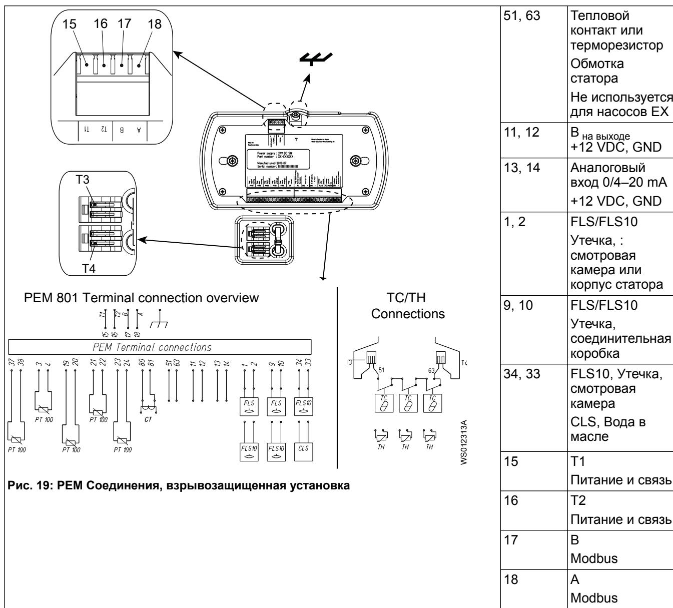
Рис. 19: PEM Соединения, взрывозащищенная установка
