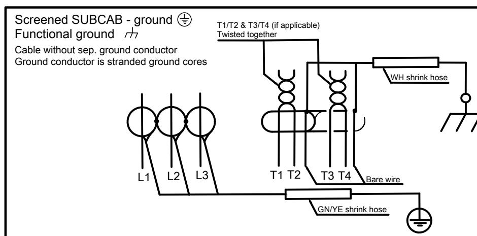
Экранированный кабель SUBCAB с функциональным заземлением Жилы T1 и T2 свиты.
