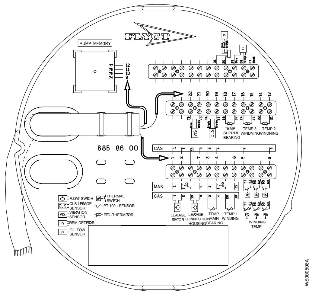
Рис. 20: MAS 711, стрелки указывают номера проводов кабеля SUBCAB
