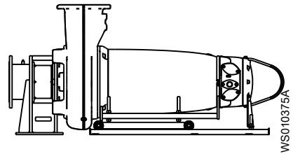
Рис. 8: Вариант Z, сервисная тележка
