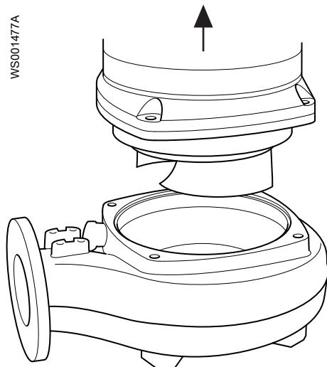
2. Снимите рабочее колесо:
