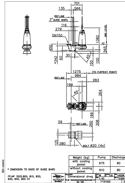
Рис. 53: Установка HT, P
