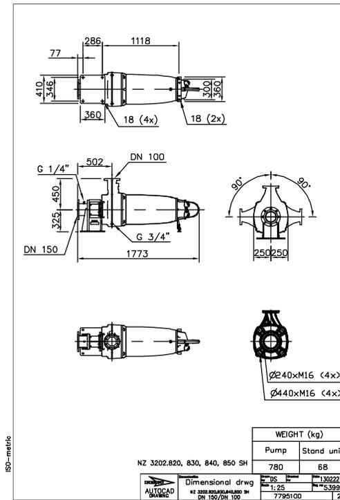
Рис. 69: Установка ST, Z
