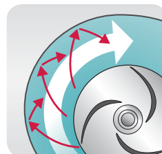
Стандартное рабочее колесо не предполагает однородность потока.
