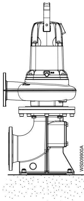
**Т** Вертикальная постоянная установка в сухом колодце с фланцевым соединением на всасывающей и нагнетательной линии.
