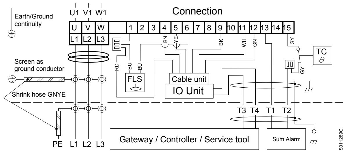
Рис. 9: Взрывозащищенное исполнение
