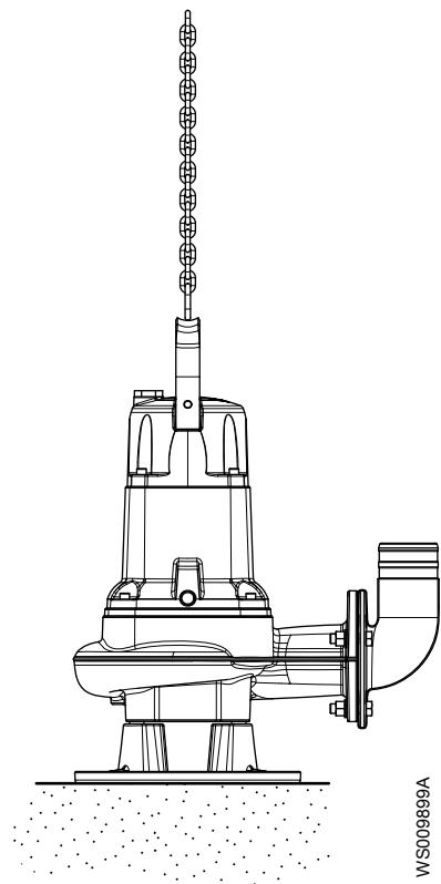
С Портативная полустационарная установка в мокром колодце с муфтой или фланцем шланга для соединения с нагнетательной линией.
