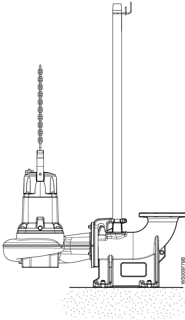
**Р** Полустационарная установка в мокром колодце с размещением насоса на двух направляющих штангах. Соединение с напорным патрубком осуществляется автоматически.
