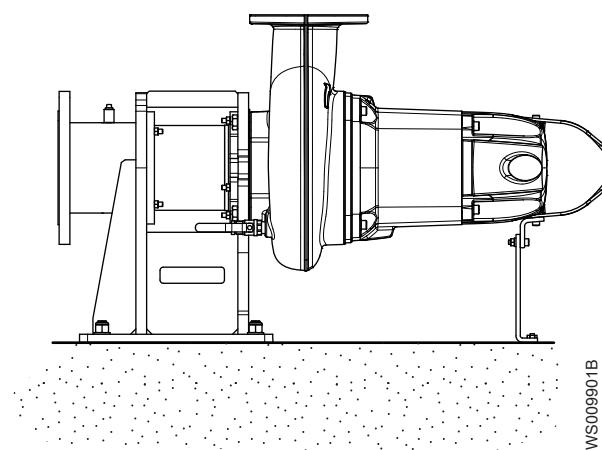
Z Горизонтальная постоянная установка в сухом колодце с фланцевым соединением на всасывающей и нагнетательной линии.
