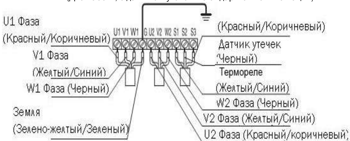
Рис. 13 Подключение по схеме Y-Δ насосов 11 кВт и выше (Три кабеля, с датчиком утечек)
